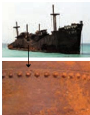
شکل ۱۳- نمونه‌ای از زنگ زدن آهن، بدنه آهنی کشتی در مجاورت هوا و رطوبت قرار گرفته و بر سطح آن زنگ آهن تشکیل شده است. فرایندی که باعث خوردگی می‌شود.
