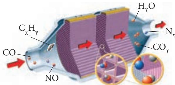
شکل ۴- در سطح سرامیک‌های درون مبدل کاتالیستی، توده‌های فلزی با قطر ۲۰ نانومتر وجود دارند.
